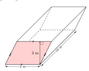
Area of end = Area of parallelogram  $= b \times h$   $= 2\,\mathrm{m} \times 3\,\mathrm{m}$   $= 6\,\mathrm{m}^2$
